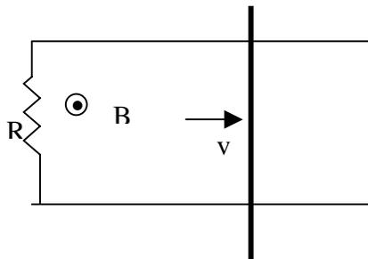
En  $t=0$ , la barra recibe un impulso de velocidad  $v_0$  en la dirección que indica la figura. La barra comienza a moverse con una velocidad  $v(t)$ .
