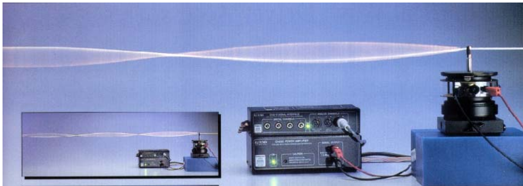
Figura 3: ondas estacionarias en una cuerda.
